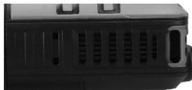
состоит из двух слоев. Первый слой находится на поверхности, а второй слой – внутри корпуса. Вместе они образуют своего рода сетку. В результате значительно снижается количество пыли, песка и мелких частей, попадающих внутрь корпуса.
